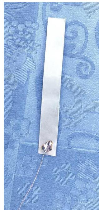
Folie innen direkt unter dem Pickup angeklebt
